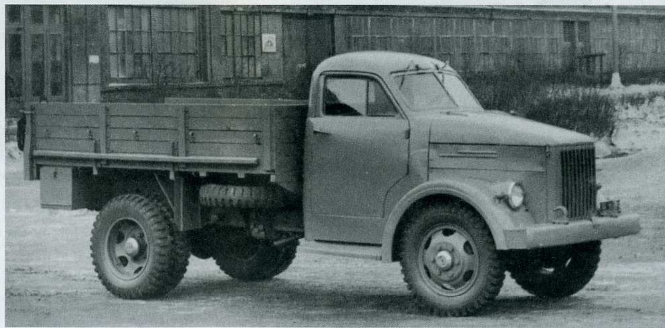
Опытный ГАЗ-11-51, построенный в январе 1939 года в двух экземплярах. Снимок сделан в Москве на ВСХВ, в 1940 году Опытный образец ГАЗ-51 во дворе завода. Кабина с переделанной дверью взята от грузовика «Студебеккер», на боковинах капота еще нет надписи «АВТОЗАВОД им. Молотова», но на хромированных колпаках ступиц выбито: ГАЗ. 1944 год
