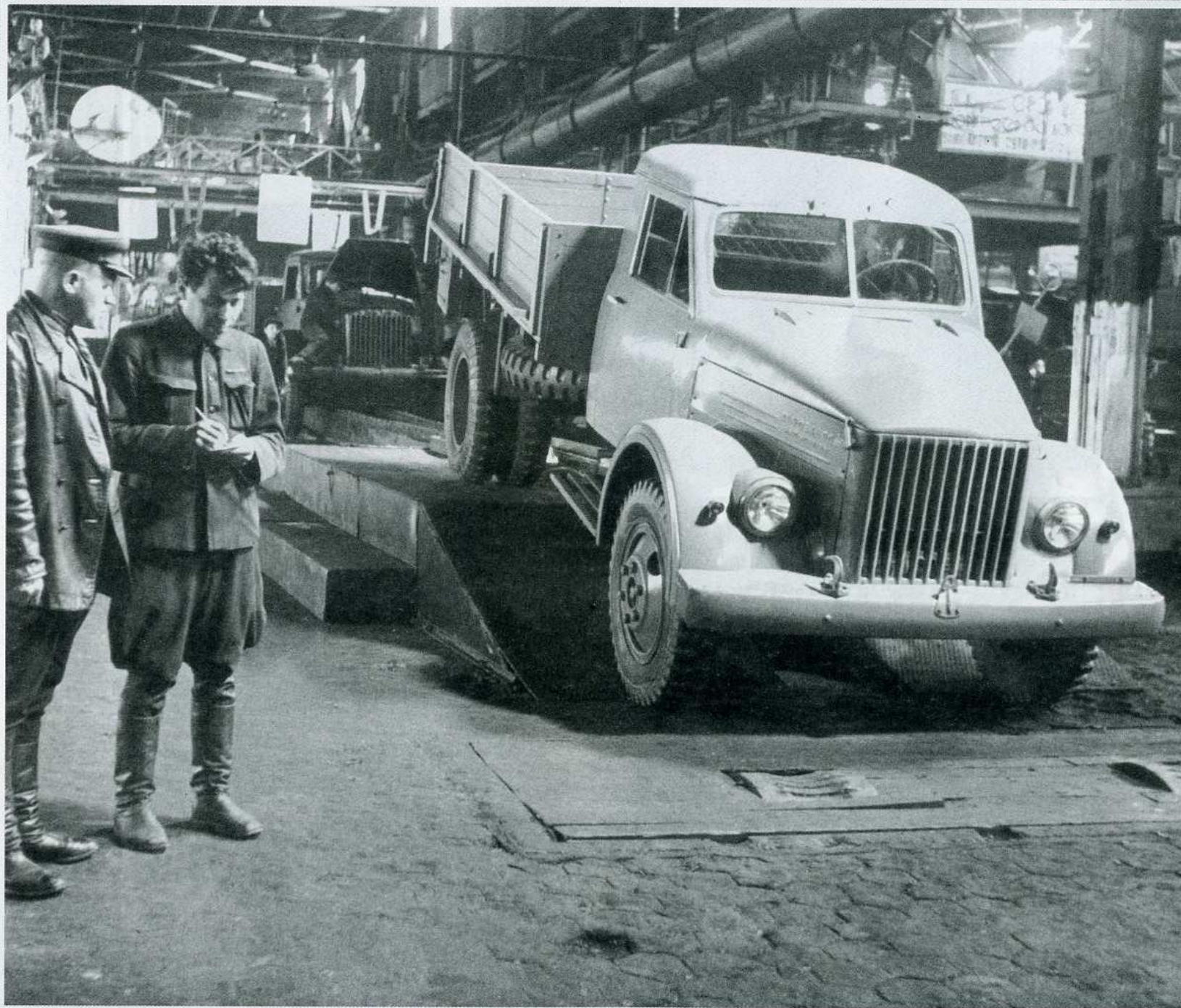
Первые ГАЗ-51 начали сходить с конвейера с 6 января 1946 года. У них была дерево-металлическая кабина, деревянные подножки, бензобак под грузовой платформой и диски колес с двумя окнами. Снимок 1946 года
