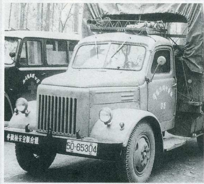
Сынри-58КА образца 1979 года значительно ушел от своего прообраза ГАЗ-51. Завод в городе Точхон выпускал также копии ГАЗ-69, КрАЗ-256, БелАЗ-51 Проверка готовых грузовиков «Сынри-58» на автомобильном заводе в северокорейском городе Дыкчхон Китайский грузовик «Ухань», изготовленный на основе ГАЗ-51А
