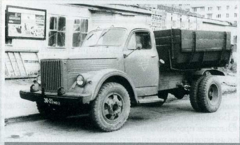
Самосвал ГАЗ-93Б для бестарной перевозки зерна и других сыпучих сельскохозяйственных грузов. Выпускался с 1958 года Саранским заводом автосамосвалов. Сельскохозяйственный самосвал ГАЗ-93Б с металлическим днищем и каркасом платформы и деревянными бортами. Сверху кузов закрывался крышкой. Самосвал ГАЗ-93С с ковшевым кузовом выпускал Одесский автосборочный завод. Надставные борта свидетельствуют, что во время «битвы за урожай» машину «мобилизовали» для перевозки зерна
