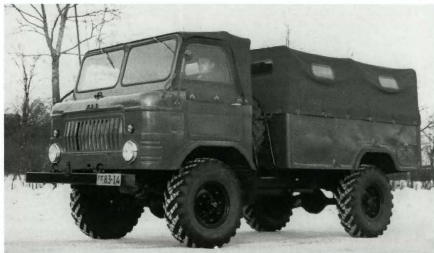
Ранний опытный образец автомобиля ГАЗ-62 с плоскими бортами кузова
