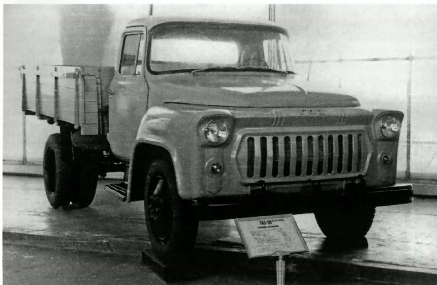
Народнохозяйственный автомобиль ГАЗ-56 грузоподъемностью 1,5 т, унифицированный по многим агрегатам с ГАЗ-62
